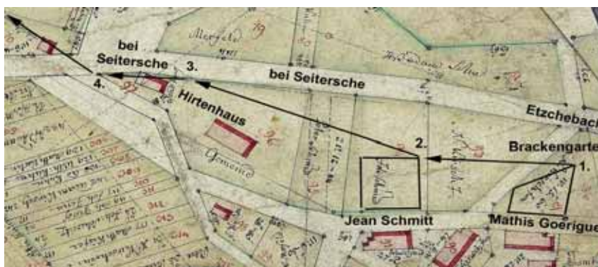
Abb. 31: Grenzsteine Nrn. 1–4 aus der 1776er Vermessung, in die Generalkarte aus dem Jahr 1790 eingezeichnet.
