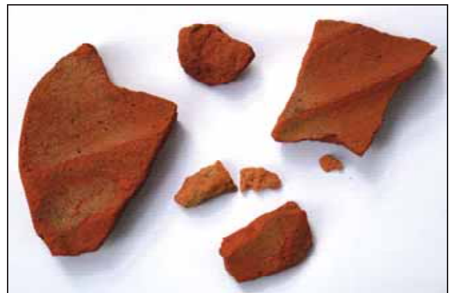
Abb. 49: Unter und neben einem Grenzstein in 60–70 cm Tiefe gefundene Bruchstücke von Ziegeln als Zeugen.
